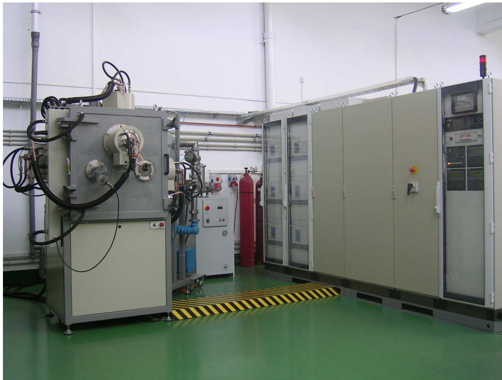
Urządzenie technologiczne typu: STANDARD-1 do wytwarzania warstw hybrydowych typu „warstwa azotowana / powłoka PVD”
