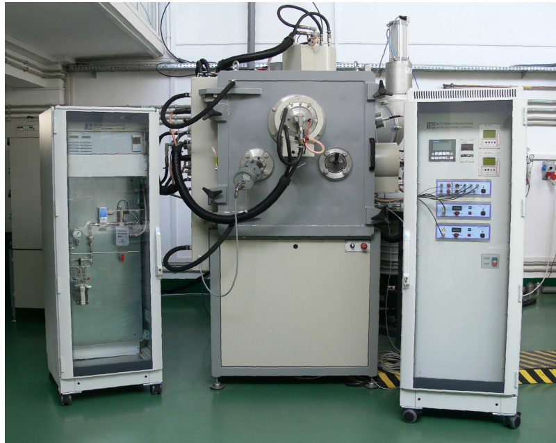
Wielofunkcyjne stanowisko technologiczne do wytwarzania warstw hybrydowych typu
